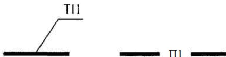
Рисунок 6 Буквенно-цифровое обозначение трубопроводов или воздуховодов
